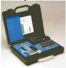
Для анализа газа SF6, который используется в установках электротехники и энергетики. С помощью дозирующего устройства и Dräger Detector Tubes® можно измерять содержание загрязнений типа влаги (точка росы) и кислоты в изолирующем газе. Результат получается через несколько минут; его можно оценить по прилагающейся таблице.
